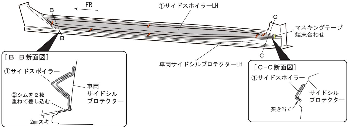
2. 下図を参照し、①サイドスポイラーの各部の隙や取り付けバランスを確認して、両面テープの離型紙を番号順に矢印の方向へ剥がし圧着する。
