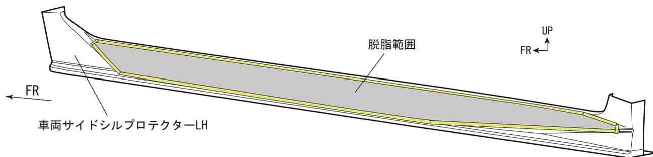
6. 下図を参照し、車両サイドシルプロテクターの両面テープ貼り付け部に③PAC プライマー N-200 を塗布する。
