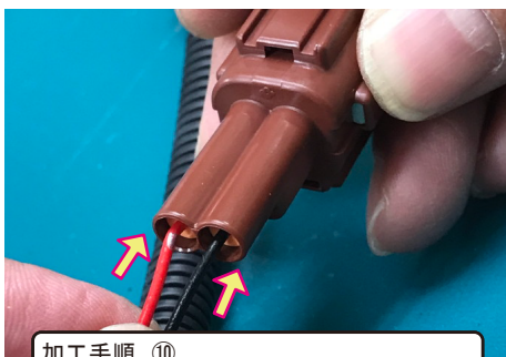
加工手順 ⑩ Mコネクタの端子差し込み方向から見て、左側に赤色配線、右側に黒色配線を差し込み、端子がロックされたことを確認してください。
