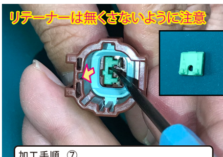
加工手順 ⑦ Mコネクタからリレーを取り外してください。
