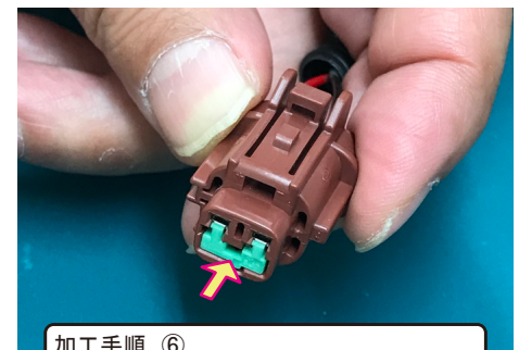
加工手順 ⑥ Fコネクタの嵌合面にリレーを取付けてください。
