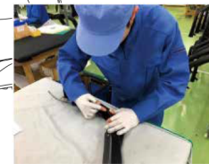
6.組み立て工程 小部品・両面テープ・モール組み立て
