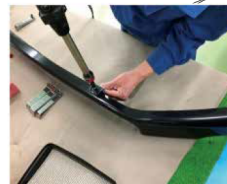
4.加工工程 金具組み付け・端末処理・表面研磨
