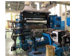
1.製板工程 材料ペレットから板材へ成形
